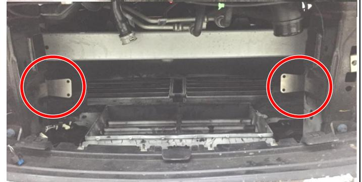
Setzen Sie den WagnerTuning Ladeluftkühler von unten an die soeben installierten oberen Edelstahlbleche an und befestigen Sie den Ladeluftkühler mit Hilfe der mitgelieferten M8 Innensechskantschrauben. Jetzt können die M8 Muttern fest angezogen werden.
